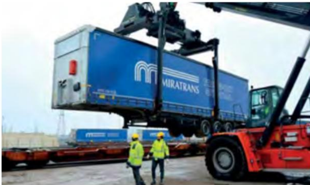
Rys. 2.3 Przeladunek naczepy za pomocą kleszczy reachstackera [49]
