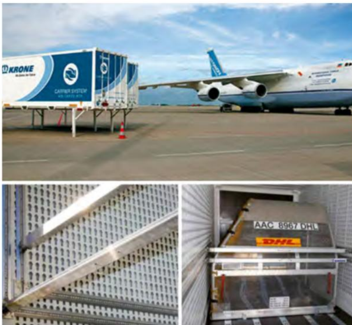
Rys. 2.24 Nadwozie wymienne Air Cargo Box [65]
