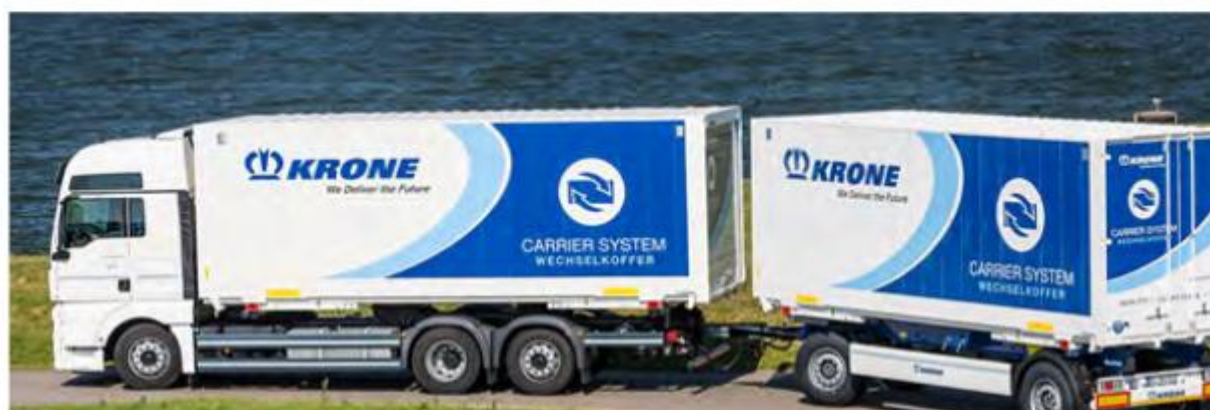
Rys. 2.23 Standardowe nadwozie wymienne [65]
