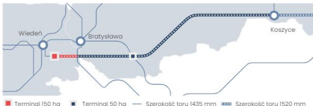
Rys. 4.3 Szeroki tor linii łączącej Koszyce z Bratysławą i Wiedniem – styk między siecią kolejową o rozstawie 1435 mm i 1520 mm [109]
