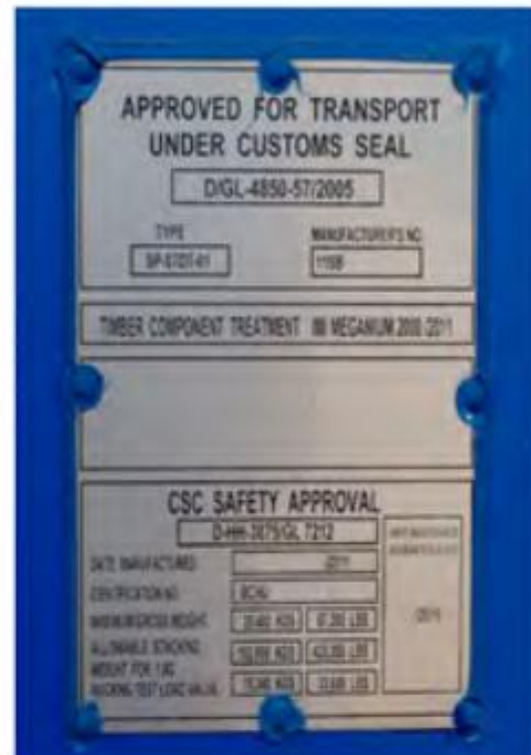
Rys. 2.19 Przykładowa tabliczka CSC [60]
