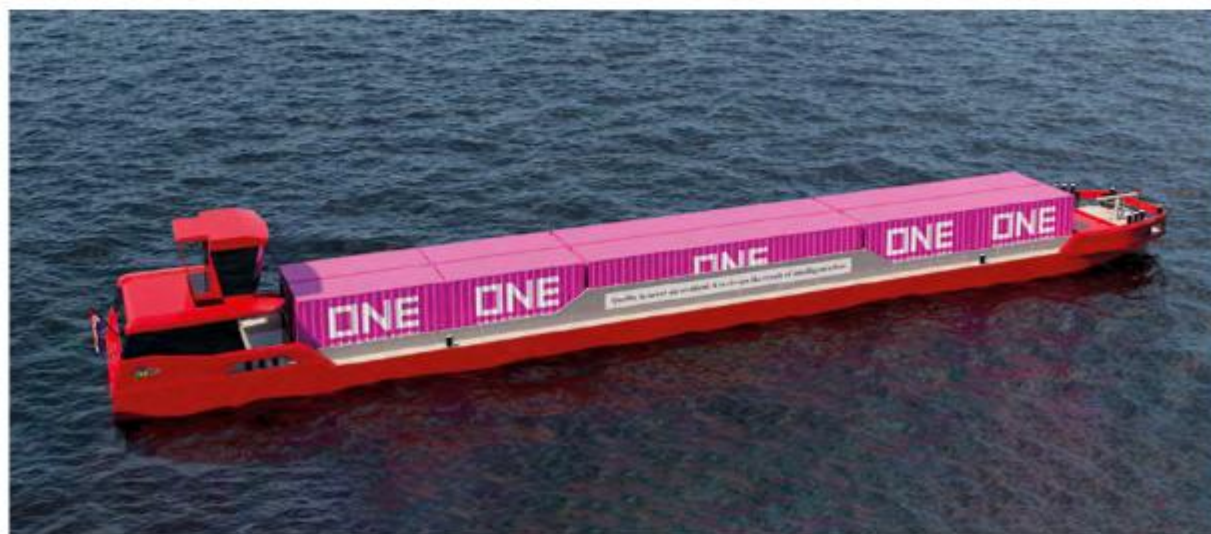
Rys. 2.29 Projekt barki elektrycznej PortLiner EC52 [75]
